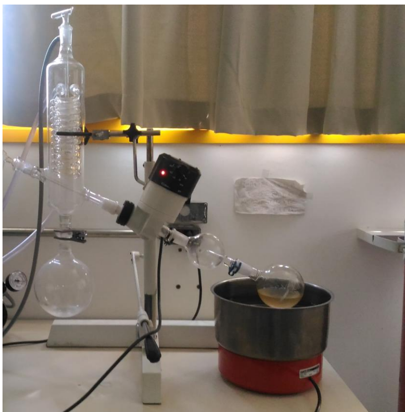
Figura 6 - Sistema utilizado para rotaevaporação
