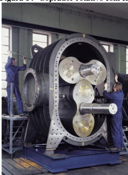
Figura 14 - Soprador rotativo com capacidade de 100.000 m 3 /h.
