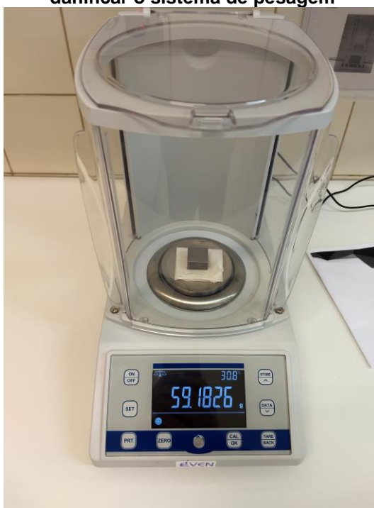
Fotografia 1 - Medição de massa utilizando balança analítica com calço de papel para não danificar o sistema de pesagem
