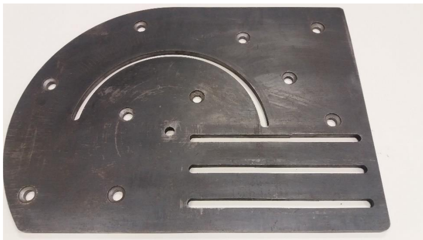
Figura 31- Base denominada Placa cortada a laser e escareada para uso de parafusos de cabeça chata
