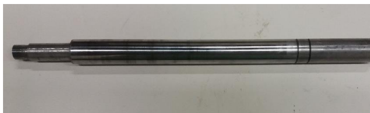
Figura 39- Haste de amortecer de veículo utilizada como eixo rotativo e fixador da ferramenta de corte
