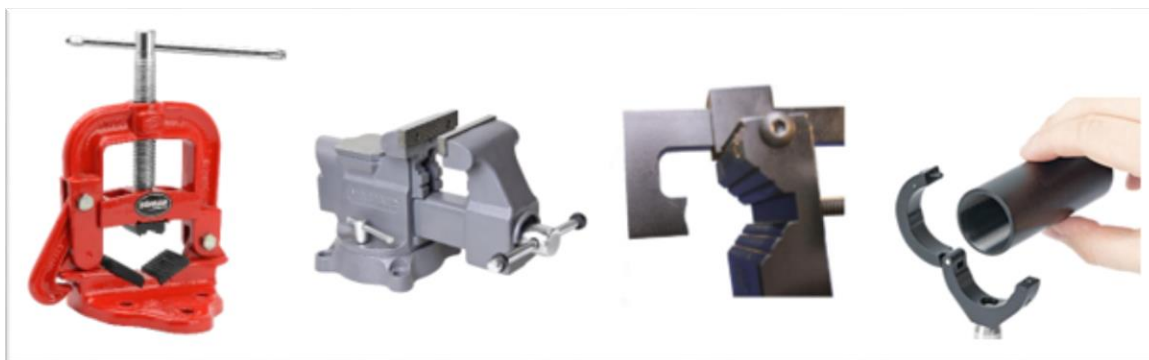
Figura 20- Elementos fixadores de tubos para execução de corte
