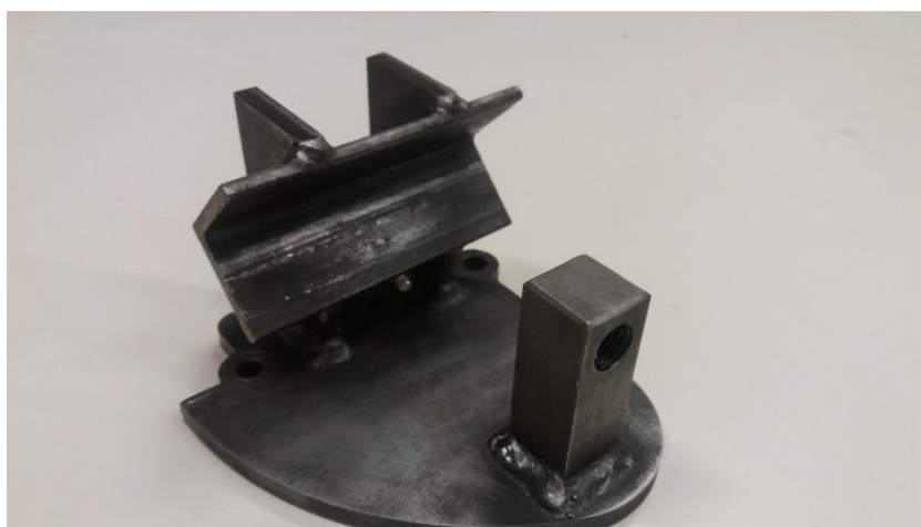
Figura 36- Morsa de tubos com partes soldadas por MIG/MAG Argônio com 25% de Gás carbônico
