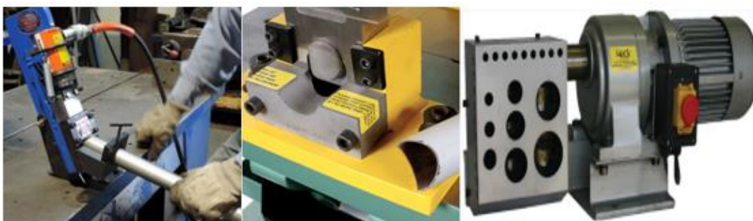
Figura 14- Máquinas por corte de cisalhamento para a fabricação de boca de lobo em tubos
