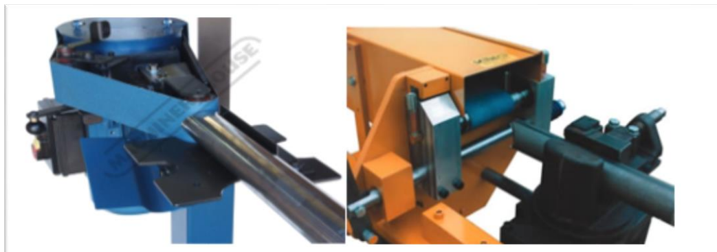
Figura 15- Máquinas para a fabricação de bocas de lobo que utilizam usinagem por geometria não definida.
