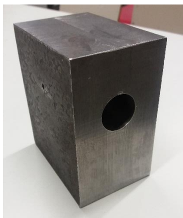
Figura 32- Suporte do Eixo rotativo fresado e furado para a inserção de buchas de latão
