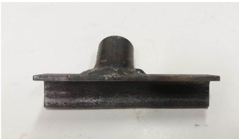
Figura 37- Mordente móvel soldado utilizado para fixação de tubos de 25 mm para execução de cortes
