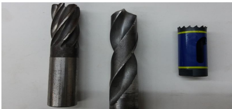
Figura 21- Elementos de usinagem de geometria definida para fabricação de furos de 25 mm
