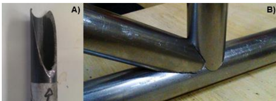
Figura 2- Modelo de corte em forma de boca de lobo utilizado para encaixe de tubos
