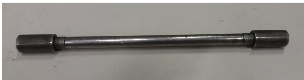
Figura 38- Alavanca de torque utilizada para rosquear e fixar tubos na morsa modificada
