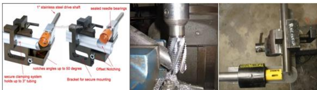
Figura 16- Máquinas para a fabricação de encaixes tipo boca de lobo utilizando usinagem por geometria definida.
