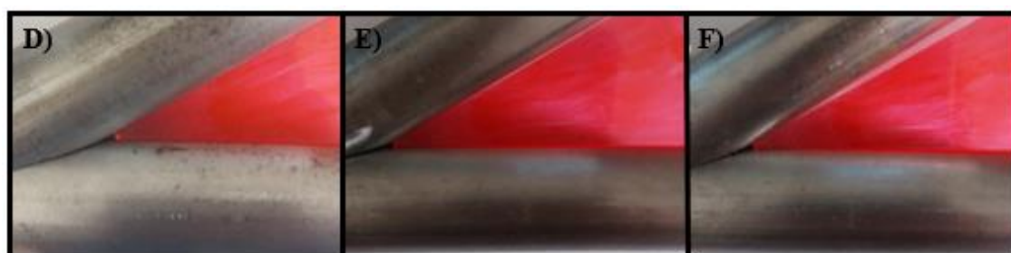
Figura 43- Avaliação visual de encaixe utilizando instrumento de desenho em ângulo de 30° graus
