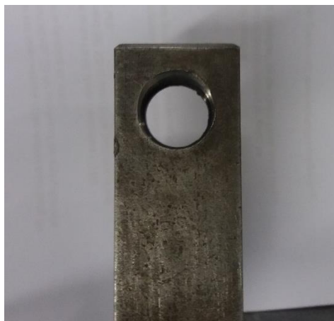
Figura 35- Rosca interna usinada em placa de quatro castanhas
