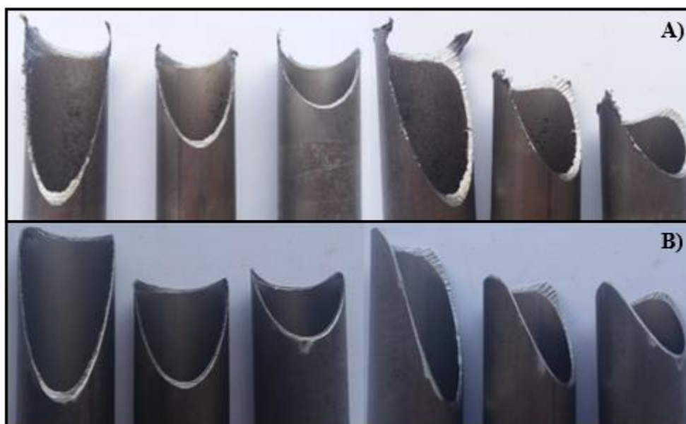
Figura 41- Comparativo do corte em forma de bocas de lobo antes (A) e depois (B) do processo de retirada de rebarbas dos tubos de 25 mm
