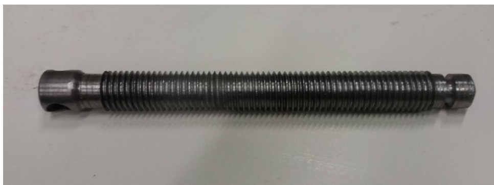
Figura 34- Fuso usinado para utilização na morsa de tubos
