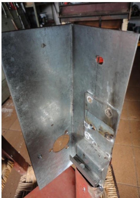
Fotografia 15: Chapas principais e de suporte do gatilho com as furações.
