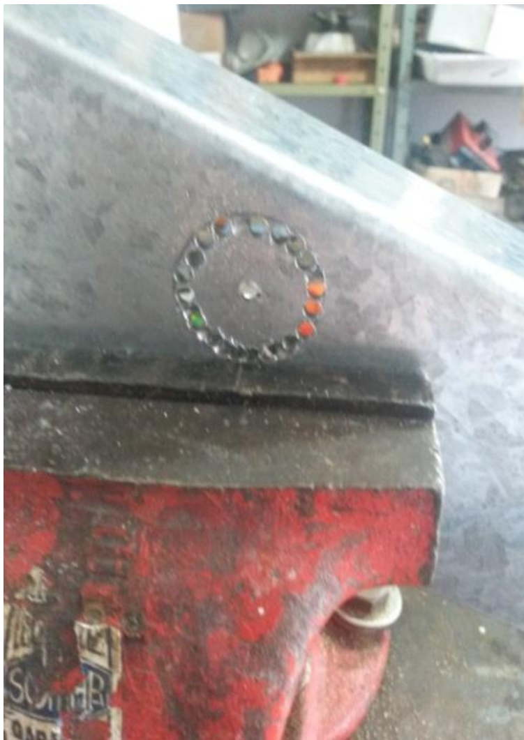
Fotografia 14: Furação inicial do furo de suporte do módulo de disparo.
