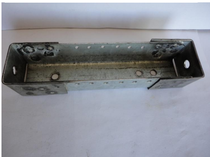
Fotografia 20: Estojo guia com suas três chapas soldadas.
