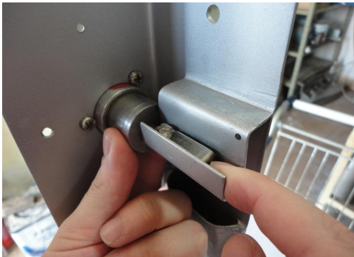
Fotografia 33: Montagem do Gatilho rosqueado.
