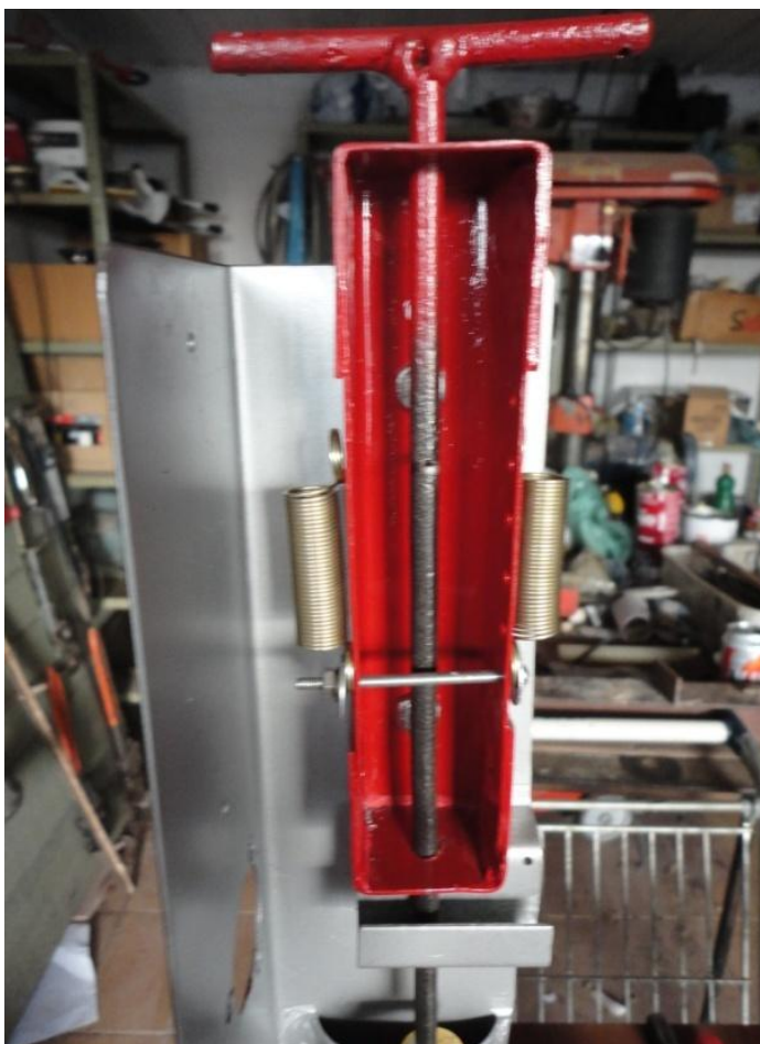
Fotografia 31: Montagem do Módulo de acionamento na Chapa principal.
