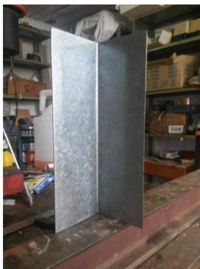
Fotografia 13: Chapa principal antes de receber os furos.
