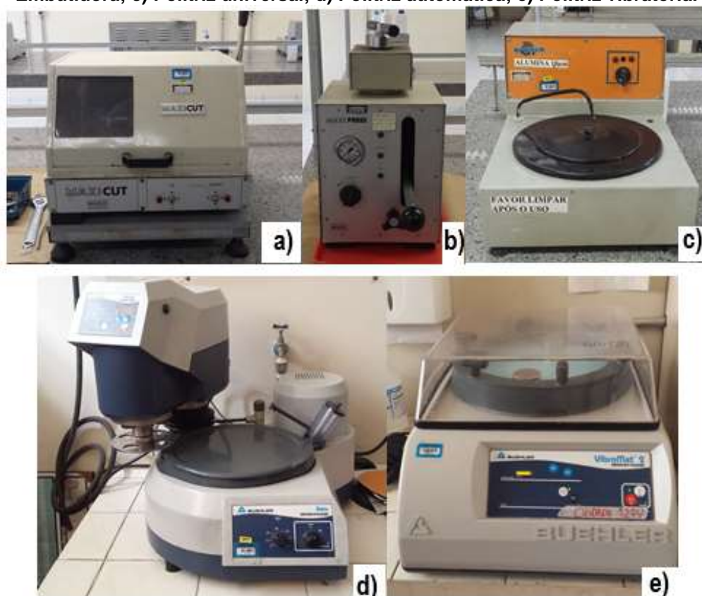
Figura 22 - Equipamentos utilizados na preparação dos corpos de prova: a) Cortadeira; b) Embutidora; c) Politriz universal; d) Politriz automática; e) Politriz vibratória.
