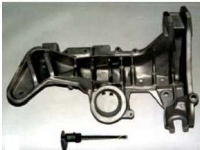
Figura 4 - Suporte de suspensão traseira Multi-link feito a partir de material semi-sólido.
