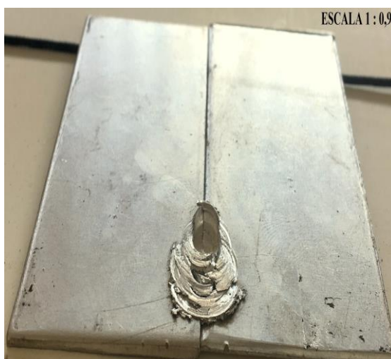
Figura 34 – Visão Superior da União Realizada com a Ferramenta 3 (1) Fonte: Autoria Própria
