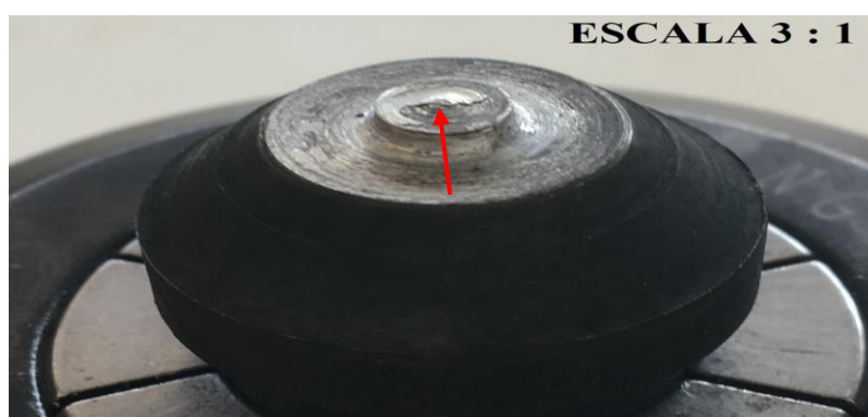
Figura 36 – Ferramenta 3 (nitretada) com possível acúmulo de material (Emplastamento) Fonte: Autoria Própria
