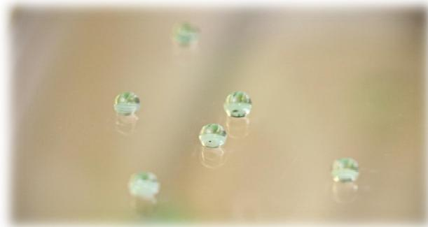
**Figura 13 - Fino filme superhidrofóbico na superfície do vidro**
