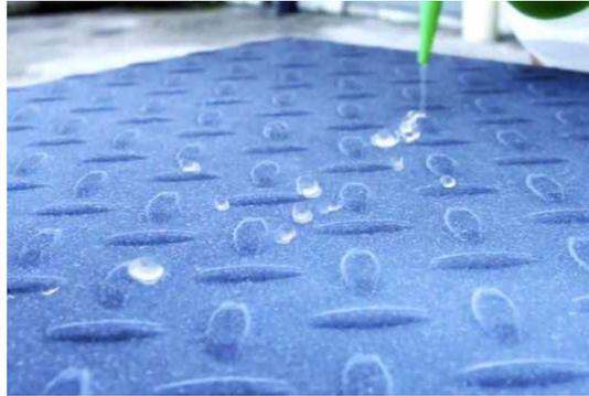
**Figura 17 - Superfície com o Ultra-Ever-Dry aplicado com o líquido sendo repelido**
