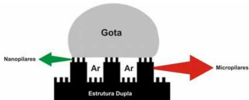
**Figura 2 - Micro e nanopilares que formam a estrutura da superfície da folha de lótus**
