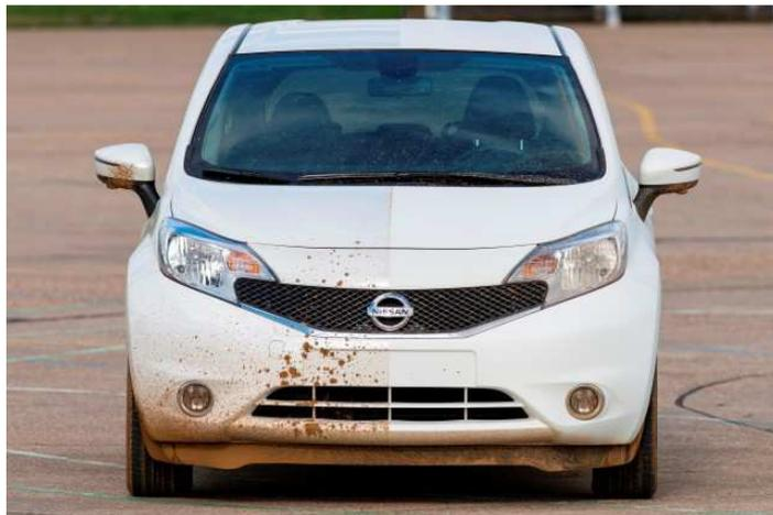
Figura 16 - Carro Nissan com o lado direito aplicado a tinta superhidrofóbica
