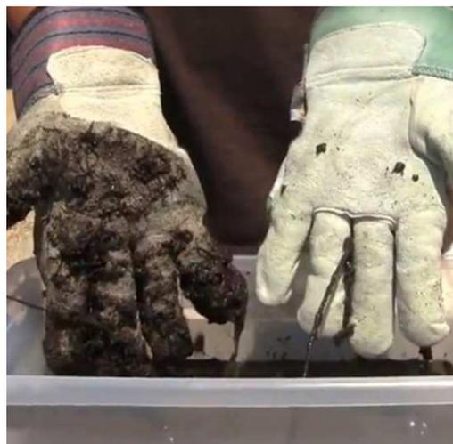
**Figura 18 - Comparação do uso de luvas com e sem o Ultra-Ever-Dry aplicado**
