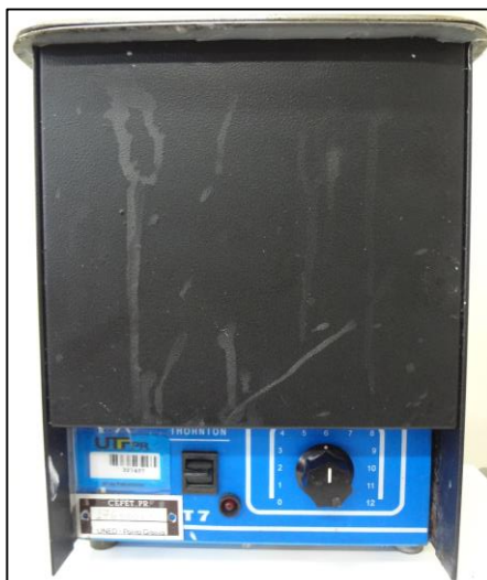
Figura 13 - Equipamento para a limpeza por ultrassom.
