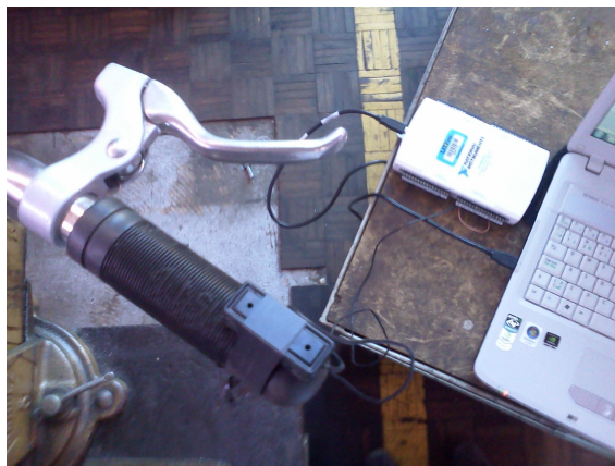
Figura 13: Detalhes da placa de aquisição, posição e fixação do acelerômetro
