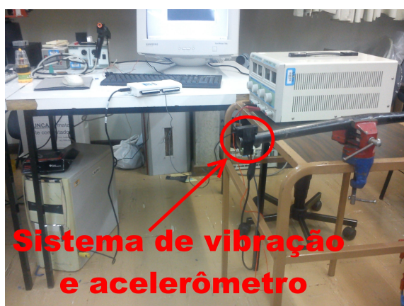
Figura 27: Montagem para a afinação experimental do sistema de vibração induzida
