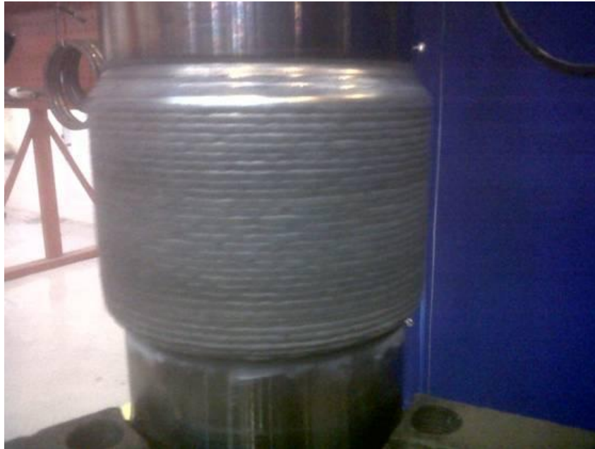
Figura 5 - Soldagem de revestimento externo
