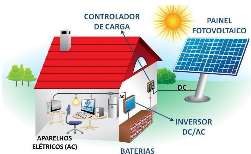
Figura 21 - Sistema isolado (Off-grid) e seus componentes.
