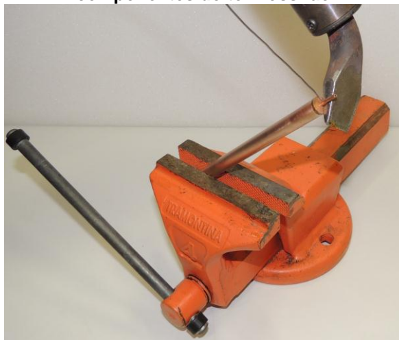
Figura 7 - Demonstração do procedimento de brasagem realizado para a união dos componentes do termossifão.
