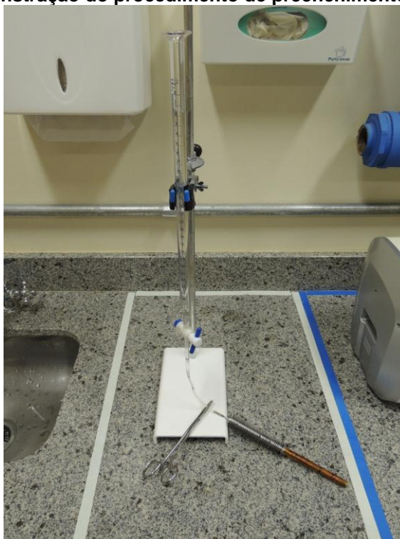
Figura 9 - Demonstração do procedimento de preenchimento do termossifão.
