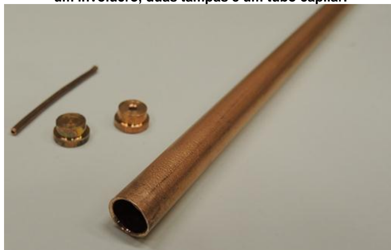
Figura 5 - Componentes utilizados para a montagem do termossifão: um invólucro, duas tampas e um tubo capilar.
