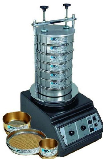
Figura 11 - Representação de um agitador eletromagnético e peneiras
