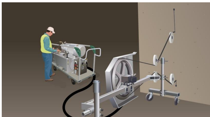
Figura 1 - Máquina de corte com fio helicoidal
