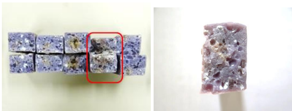
Fotografia 19 – Amostras do grupo B após ensaio de flexão
