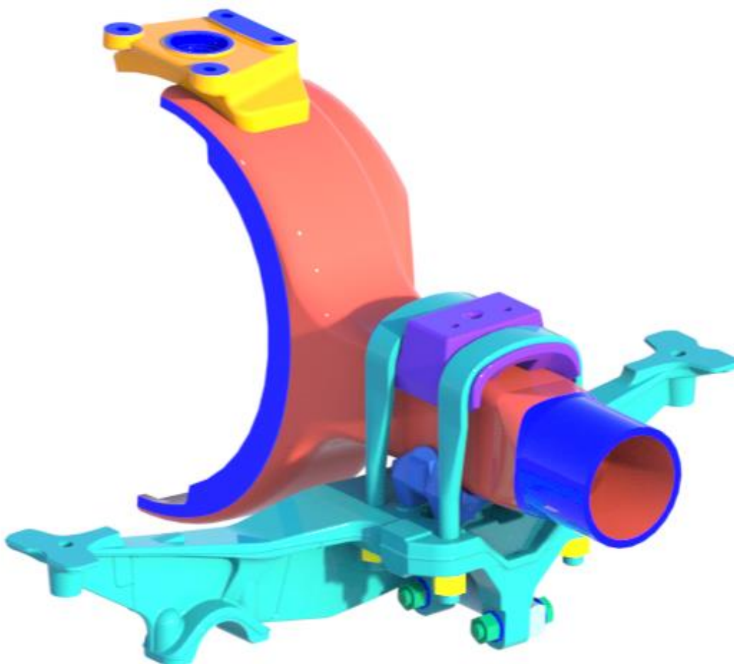
Figura 13 – Modelo Simplificado da Suspensão Pneumática Fonte: Empresa
