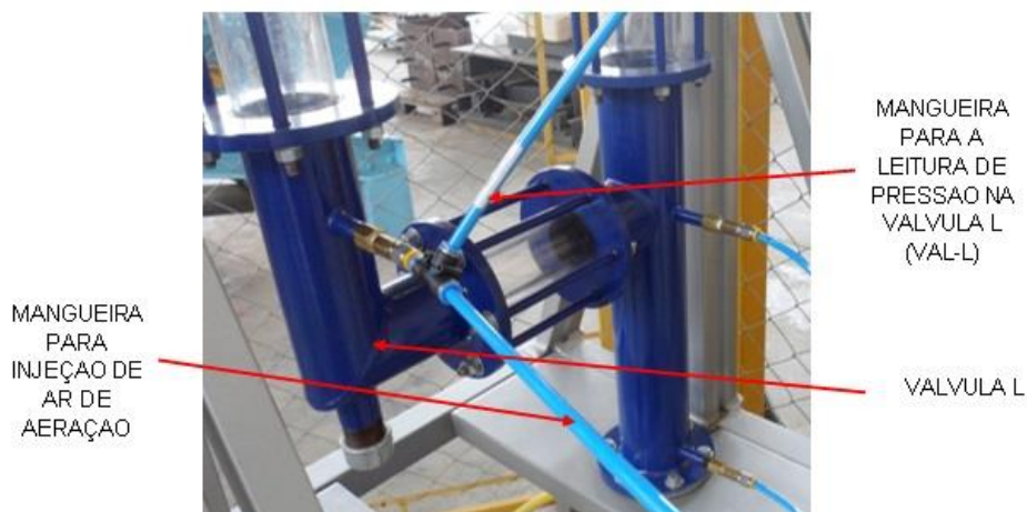
Figura 18 – Válvula de retorno dos sólidos tipo L. Fonte: Adaptado de Valaszek e Marin.
