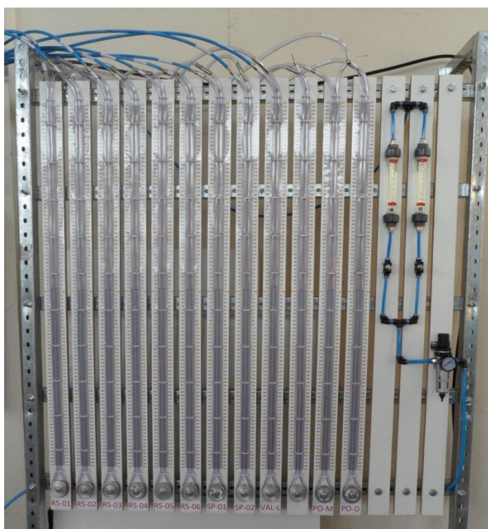
Figura 22–Painel com manômetros em “U”. Fonte: Valaszek e Marin (2013).
