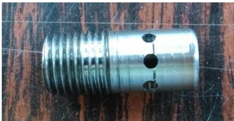
Figura 27 – Tuyere separado da placa base. Fonte: Autoria própria.
