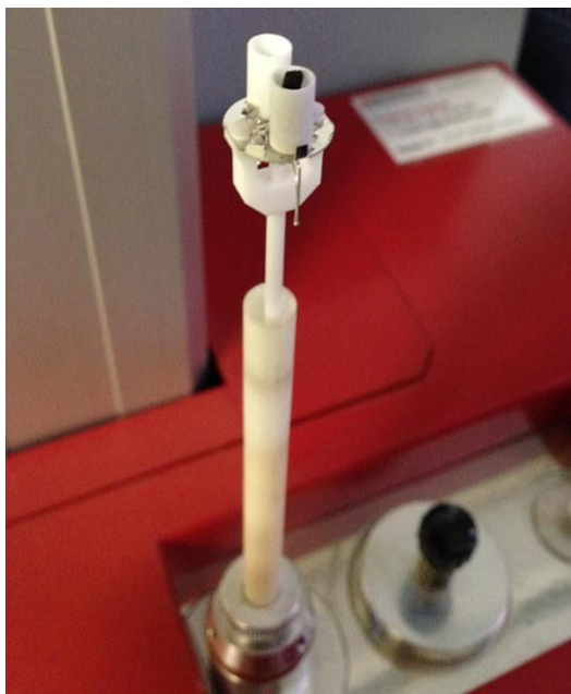
Figura 10 - Haste Composta LABSYS evo TG 1600 com Cadinhos
