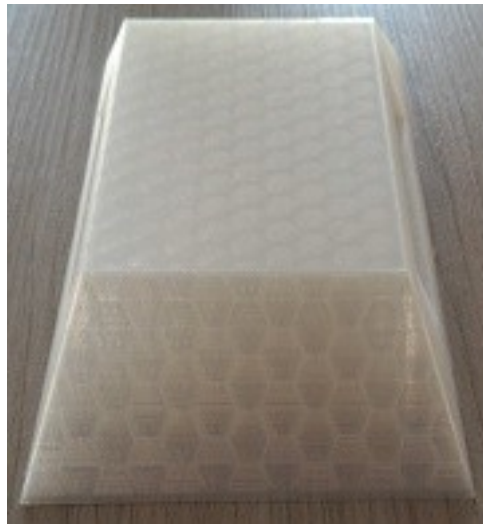
Figura 18 – Vista Lateral do Tachão Refletivo em Impressão 3D.
