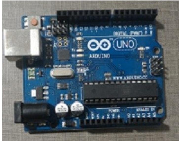
Figura 20 – Microcontrolador Arduino UNO Utilizado Para o Controle do Sistema.
