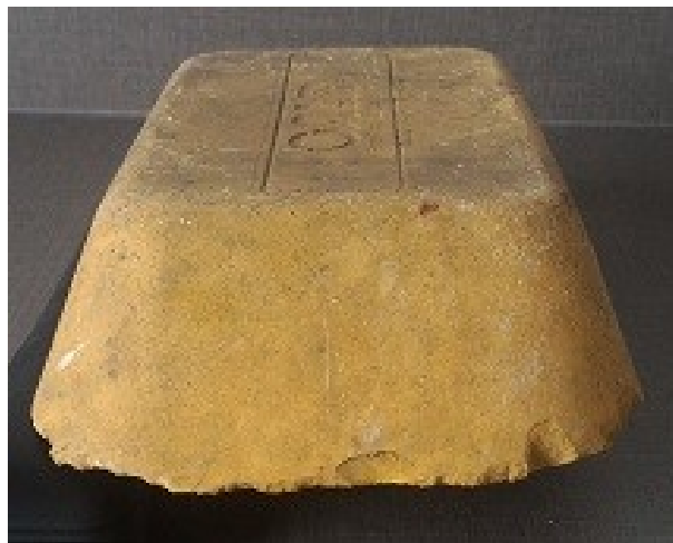
Figura 11 – Vista Lateral do Tachão Refletivo Amarelo Convencional Utilizado como Modelo.
