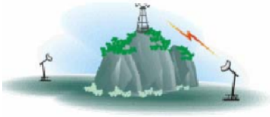
Figura 8 – Uso de repetidores em decorrência do relevo.
