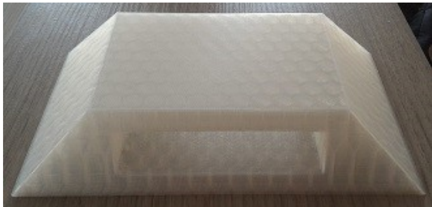
Figura 16 – Vista Frontal do Tachão Refletivo em Impressão 3D.
