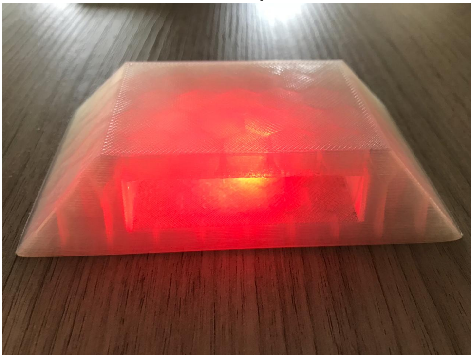
Figura 34 – Tachão Refletivo Desenvolvido com Iluminação em LED.
