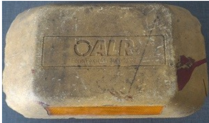
Figura 10 – Vista Superior do Tachão Refletivo Amarelo Convencional Utilizado como Modelo.
