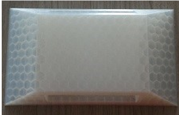
Figura 17 – Vista Superior do Tachão Refletivo em Impressão 3D.
