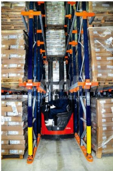
Figura 5 - Empilhadeira dentro do Drive-In
