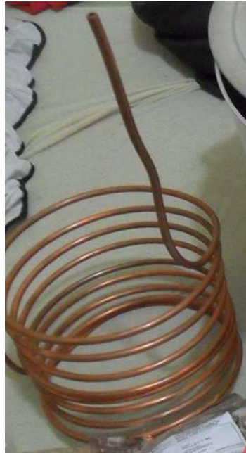
Figura 8 – Chiller de imersão
