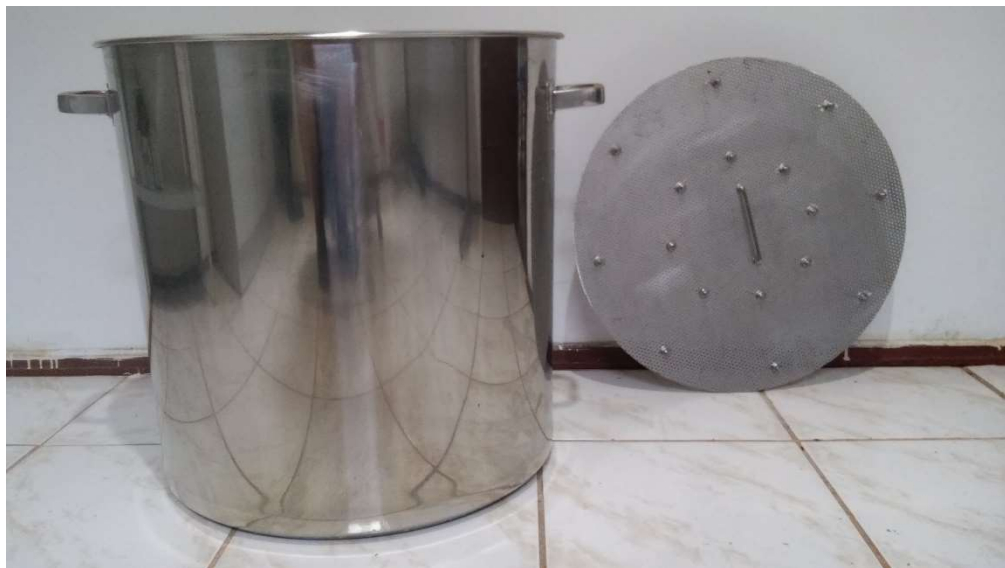
Figura 2 – Caldeirão de mostura (à direita) e fundo falso (à esquerda)
