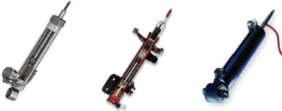
Figura 6 – Amortecedores eletronicamente controlados. Da esquerda para a direita: eletro-hidráulico, magnetorreológico e eletrorreológico.
