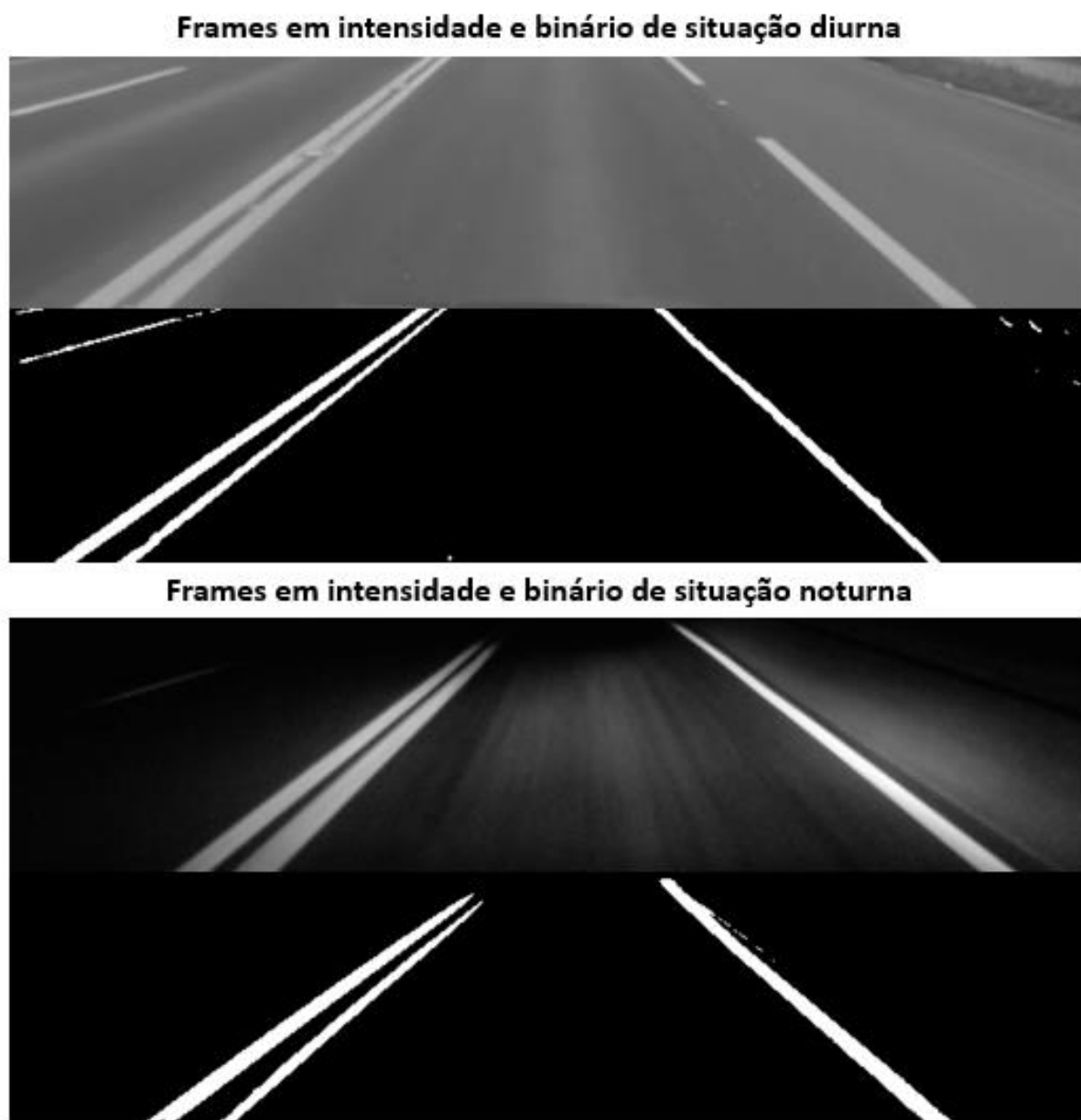
Figura 14 – Processo de binarização em situações diurna e noturna
