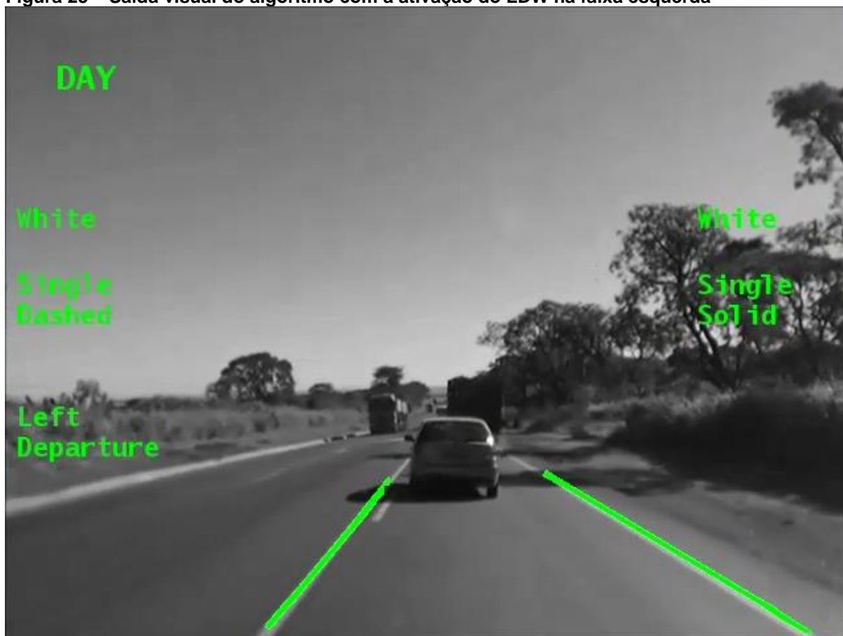
Figura 25 – Saída visual do algoritmo com a ativação do LDW na faixa esquerda
