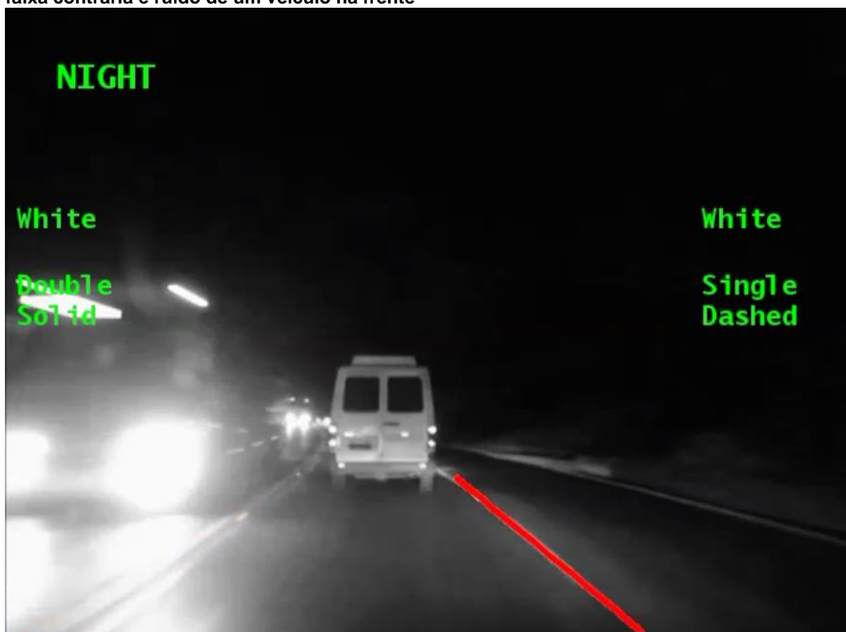
Figura 33 – Resultado da amostra 7 em situação noturna, com reflexo de faróis de veículos na faixa contrária e ruído de um veículo na frente
