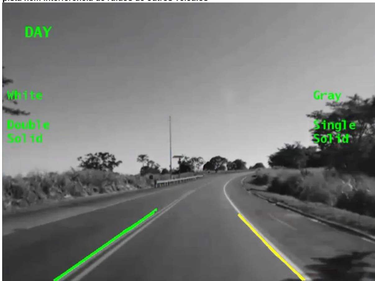
Figura 30 – Resultado da amostra 4 sem elementos que dificultaram a extração de bordas da pista nem interferência de ruídos de outros veículos
