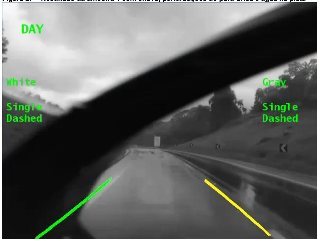
Figura 27 – Resultado da amostra 1 com chuva, perturbações do para-brisa e água na pista
