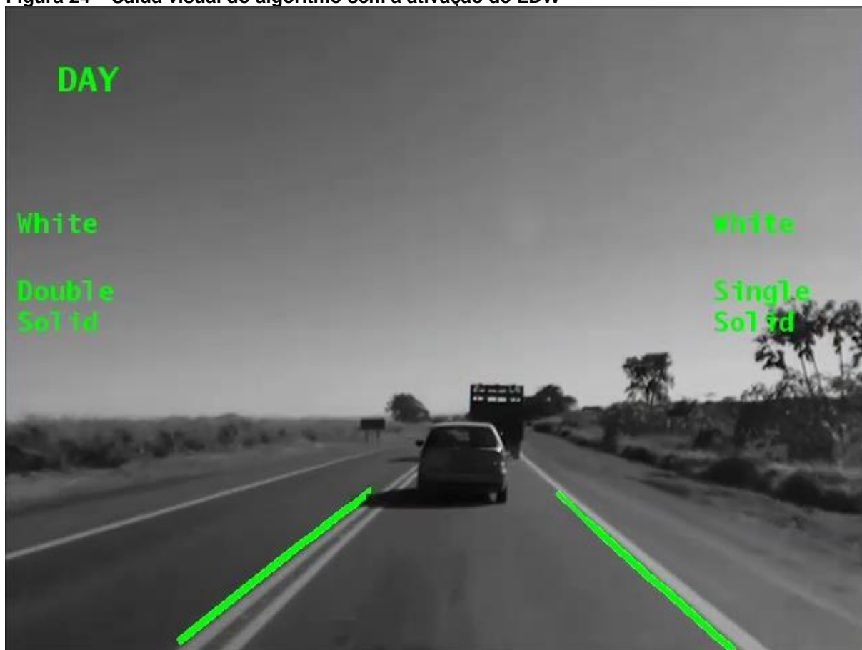
Figura 24 – Saída visual do algoritmo sem a ativação do LDW
