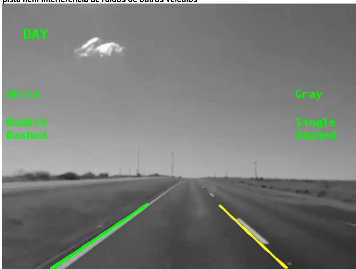
Figura 31 – Resultado da amostra 5 sem elementos que dificultaram a extração de bordas da pista nem interferência de ruídos de outros veículos
