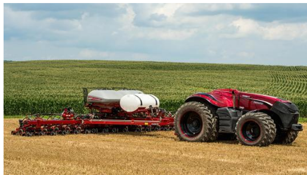
Figura 36: trator autônomo guiado por GPS
