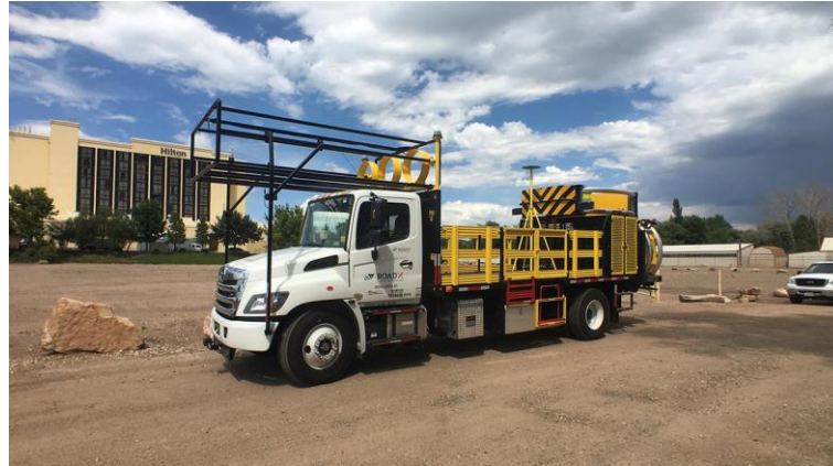
Figura 34: Primeiro veículo autônomo de construção comercializado
