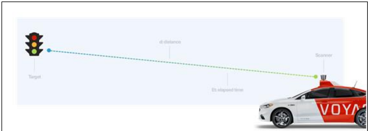
Figura 24: Captação do LIDAR
