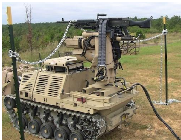
Figura 37: Robô militar guiado por controle remoto e com arma M240
