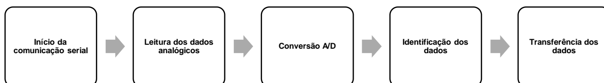
Figura 20 – Fluxograma da lógica de programação desenvolvida no Arduino Uno.
