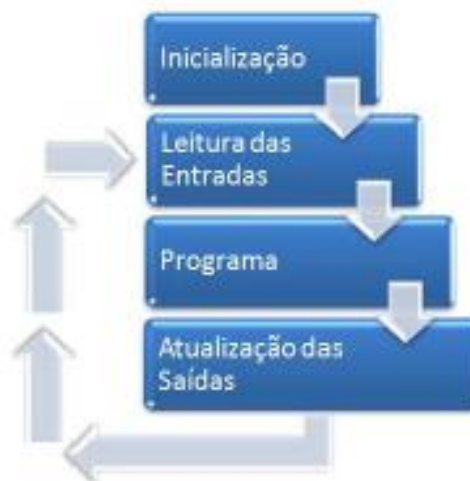
Figura 7 - Princípio de funcionamento do CLP Fonte: SILVA, 2009
