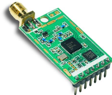
Figura 15 – Transceptor de radiofrequência UM801, embarcado com tecnologia LoRa®
