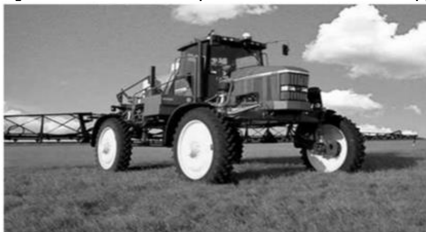
Figura 1 - Pulverizador VRT acoplado ao trator com antena de recepção GPS
