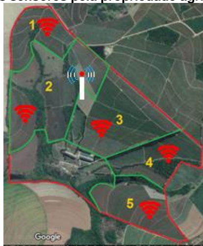
Figura 28 – Disposição dos nós sensores pela propriedade agrícola utilizando vista por satélite
