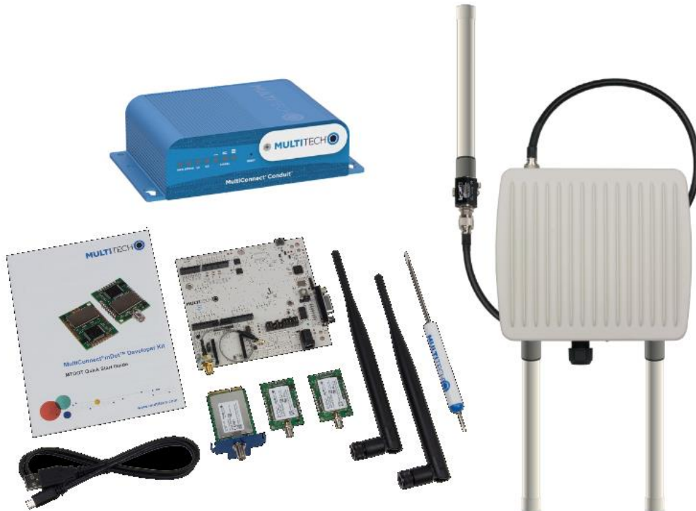
Figura 22 – Kit de equipamentos necessários para aplicação de rede LoRa® na agricultura
