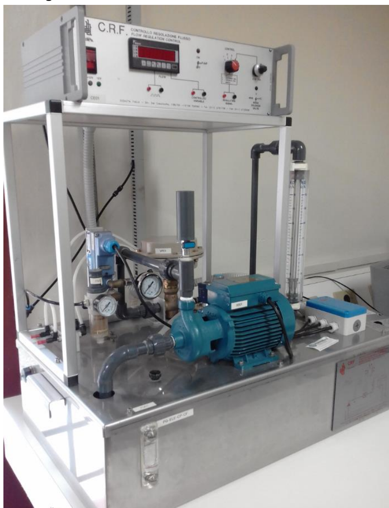
Figura 2 – Planta Didática de Controle de Fluxo
