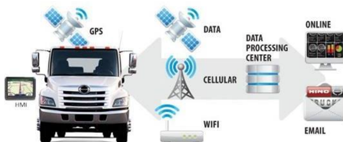
Figura 4 - Exemplo de estrutura de Telemática Automotiva
