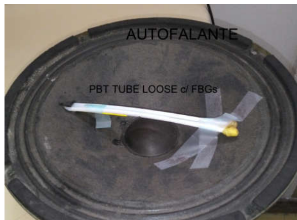
Figura 11- Fotografias com vistas da montagem experimental dos encapsulamentos no autofalante, usado como gerador de ondas mecânicas
