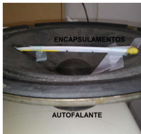
Figura 11- Fotografias com vistas da montagem experimental dos encapsulamentos no autofalante, usado como gerador de ondas mecânicas
