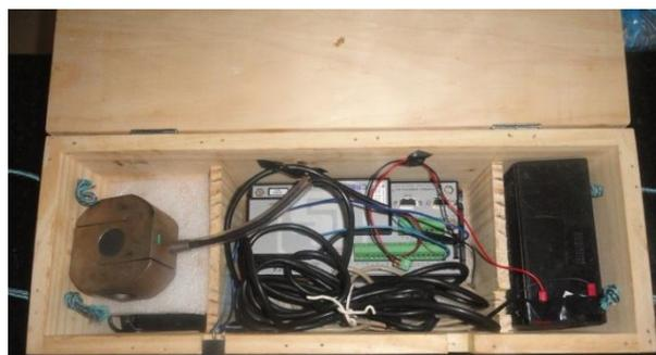
Figura 10 – Sistema de aquisição de dados, modelo CR800, utilizado no ensaio de tração durante a semeadura da cultura da soja. UTFPR, Pato Branco - PR, 2015.
