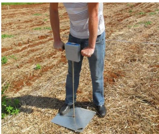
Figura 6 – Coleta de dados para avaliação da resistência mecânica do solo à penetração. UTFPR, Pato Branco - PR, 2015.
