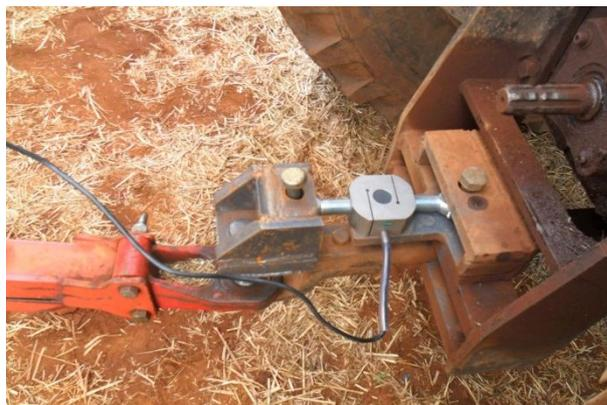
Figura 11 – Vista geral da célula de carga inserida entre o trator e a semeadora-adubadora para medição da força de tração. UTFPR, Pato Branco - PR, 2015.
