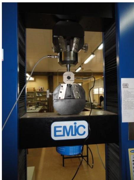
Figura 12 – Vista geral do ensaio para calibração da célula de carga utilizada no experimento. UTFPR, Pato Branco - PR, 2015.
