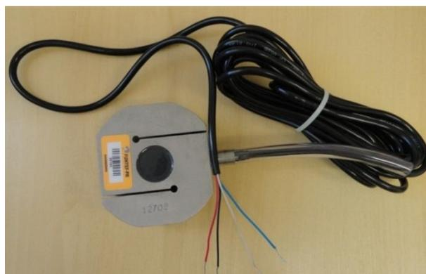
Figura 9 – Célula de carga utilizada no ensaio de tração durante a semeadura da cultura da soja. UTFPR, Pato Branco - PR, 2015.
