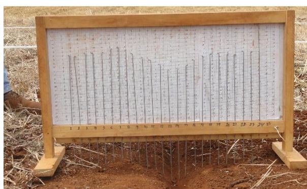
Figura 8 – Vista geral do perfilômetro de madeira utilizado para avaliação da profundidade, largura de sulco e da área de solo mobilizado. UTFPR, Pato Branco - PR, 2015.
