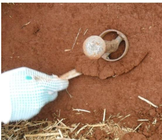
Figura 5 – Coleta de solo com anel volumétrico para avaliação de densidade do solo. UTFPR, Pato Branco - PR, 2015.
