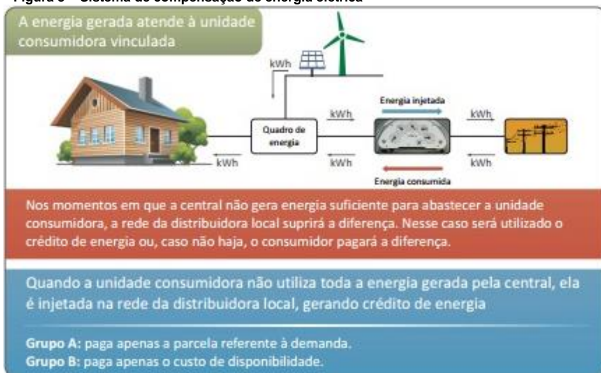
Figura 3 – Sistema de compensação de energia elétrica
