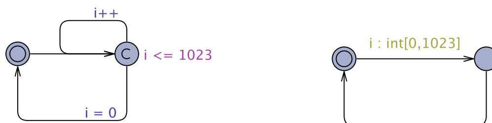
(a) Gerador de números aleatórios usado em Rosas (2014) (b) Gerador de números aleatórios proposto
