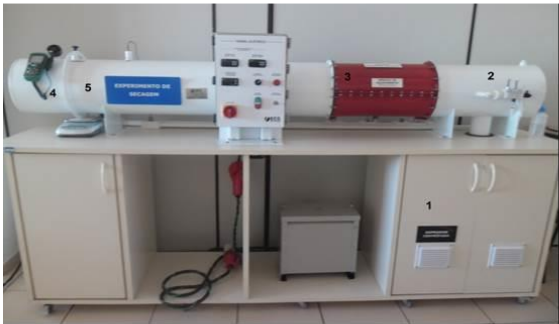
Figura 5 - Módulo didático para experimento de secagem em túnel de vento. O módulo constitui-se de: 1 - Soprador de ar; 2- Psicrômetro; 3 - Sistema de aquecimento/resistências; 4- Balança semi-analítica e anemômetro; 5- Câmera de secagem.
