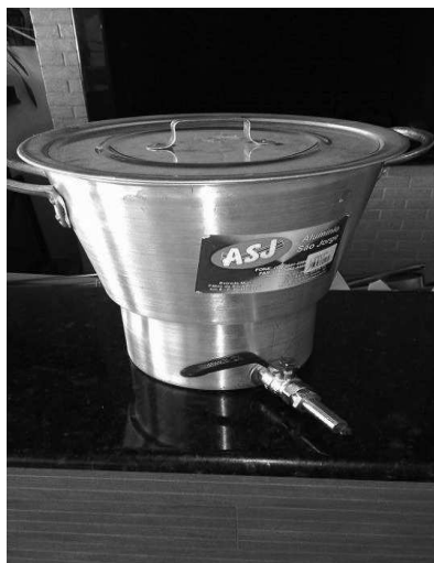
Figura 5 – Panela de filtração e mosturação de fundo falso.
