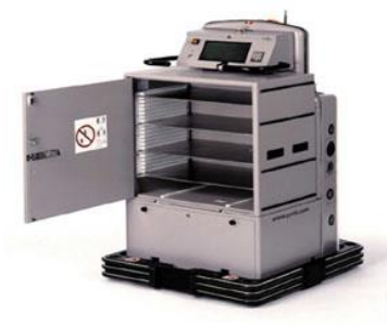
(a) Robô de hospital "HelpMate". Fonte: Jones (2003).
