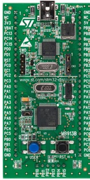
**Figura 3 - Placa de desenvolvimento STM32VLDISCOVERY**
