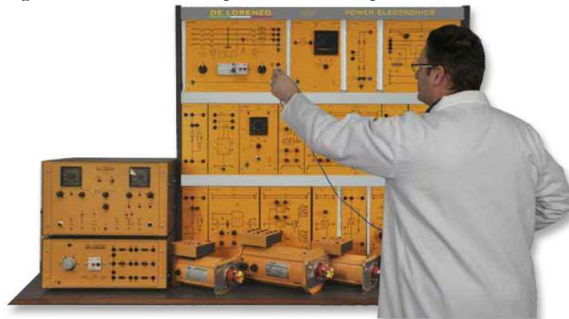
Figura 5 – Módulo didático para eletrônica de potência DE LORENZO.
