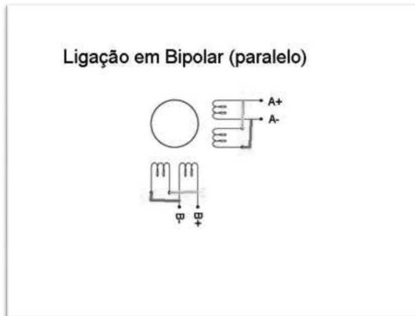
Figura 11 - Motor de Passo Bipolar 8 fios Ligação em Paralelo
