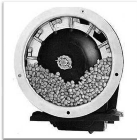
Figura 4 - Distribuidor de Sementes por Dedos Prensorees
