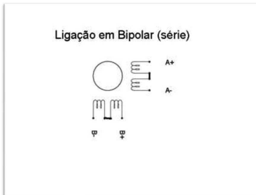
Figura 10 - Motor de Passo Bipolar 8 fios Ligação em Série
