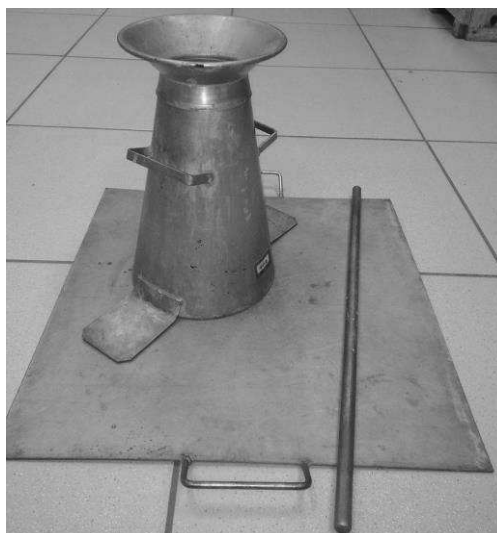
Figura 10 - Equipamentos necessários para determinação da consistência do concreto.
