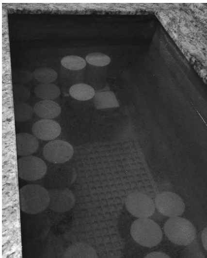
Figura 7 - Tanque para realização da cura em temperatura ambiente.
