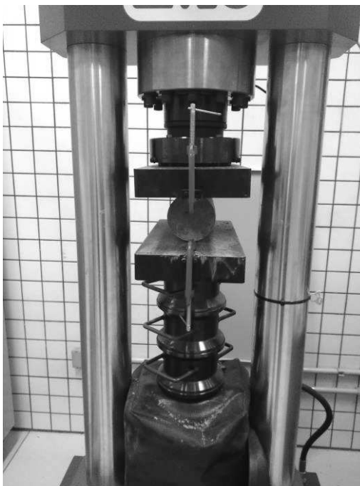
Figura 12 – Ensaio de tração por compressão diametral.
