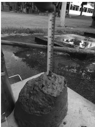
Figura 11 – Abatimento do tronco de cone.
