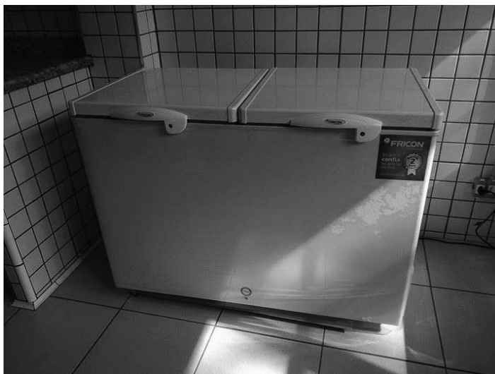
Figura 8 - Refrigerador utilizado para submeter os corpos-de-prova a temperatura de 5°C.
