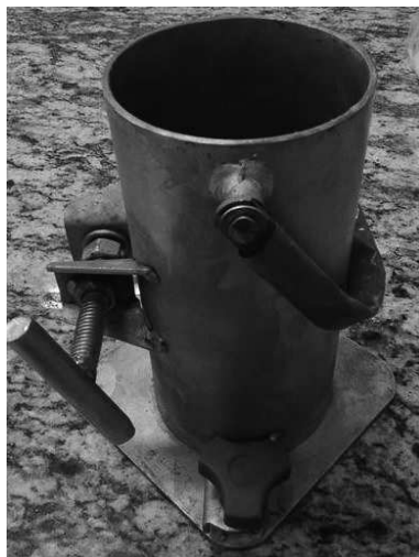
Figura 6 - Moldes cilíndricos para produção dos corpos-de-prova.
