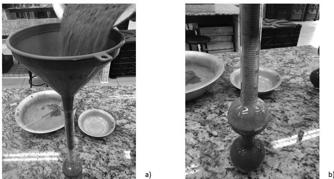
Figura 13 – Etapas do ensaio de determinação da massa específica da areia reciclada: a) inserção do agregado no frasco; e b) agregado pronto para a eliminação das bolhas de ar e partículas aderidas à parede do frasco
