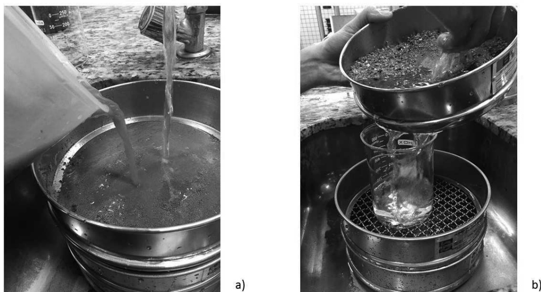
Figura 15 – Etapas do ensaio de determinação do teor de material pulverulento da areia reciclada: a) início do processo de lavagem, água escura; e b) término do procedimento de lavagem, comparação da água com aquela de coloração limpa
