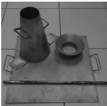
Figura 12: Equipamentos para o ensaio de consistência pelo abatimento do tronco de cone
