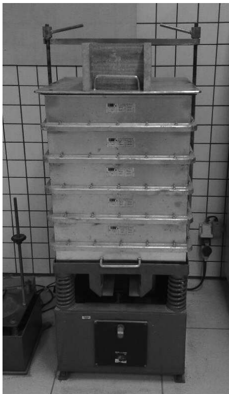
Figura 9: Agitador mecânico e conjunto de peneiras para o ensaio de granulometria do agregado graúdo
