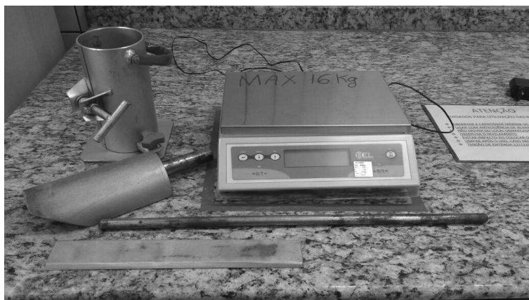
Figura 8: Equipamentos para o ensaio de massa unitária
