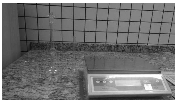
Figura 11: Materiais para realização do ensaio de massa específica do cimento.
