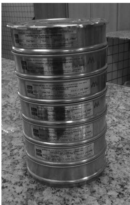
Figura 10: Conjunto de peneiras para o ensaio de granulometria do agregado miúdo
