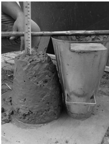
Figura 16: Abatimento do concreto com 100% de substituição.
