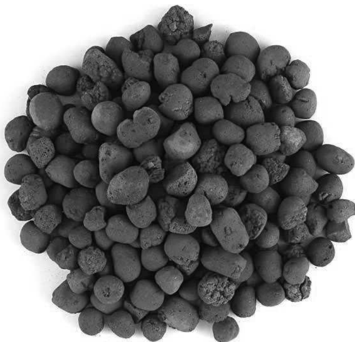
Figura 5: Argila Expandida Fonte: Leroy Merlin, 2016.
