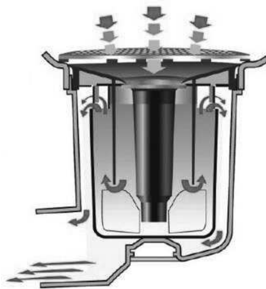
Figura 9: Funcionamento do mictório. Fonte: EcoWin, 2016
