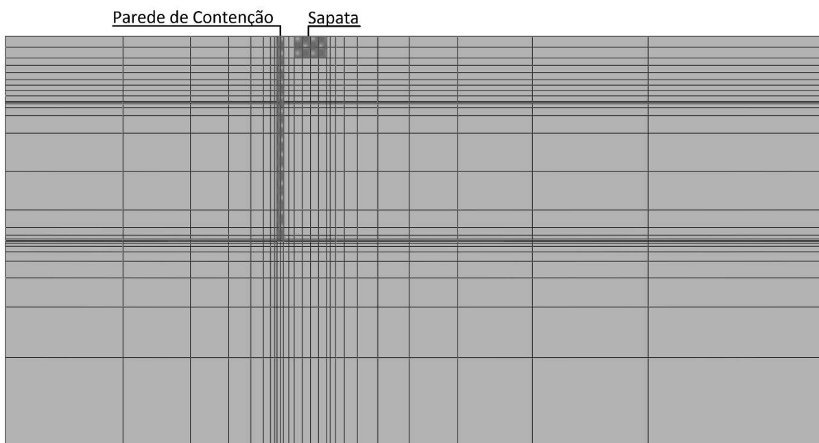
Figura 3.2 – Malha de elementos finitos.
