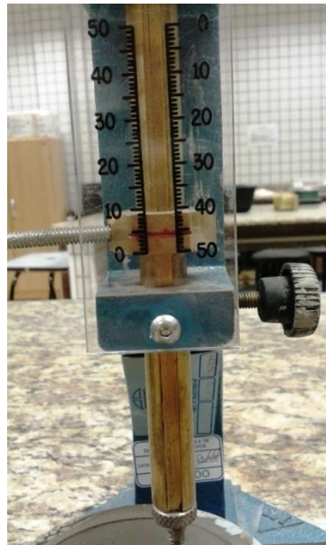
Figura 44 – Aparelho de Vicat depois de atingidos os 4 mm
