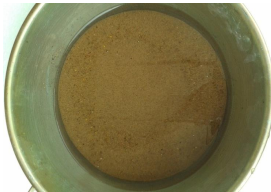
Figura 15 – Agregado contendo água após o processo de lavagem
