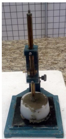
Figura 24 – Aparelho de Vicat após moldagem da pasta
