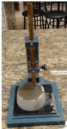
Figura 25 – Aparelho de Vicat - Início da pega
