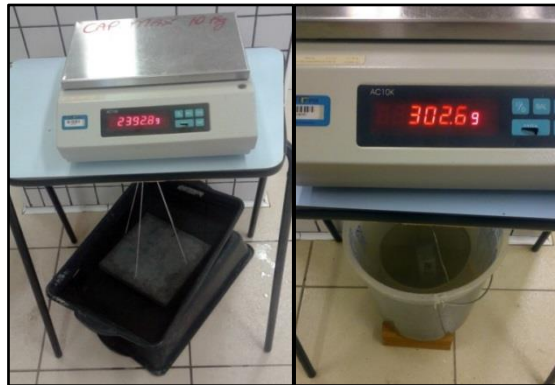
Figura 32 – Pesagem da placa e do corpo-de-prova na balança hidrostática
