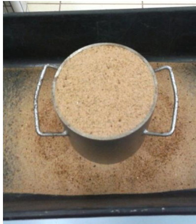
Figura 18 – Recipiente contendo o agregado compactado
