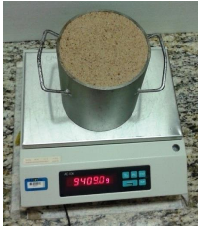
Figura 17 – Recipiente contendo o agregado no estado solto
