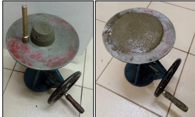
Figura 27 – Argamassa após a retirada do molde
