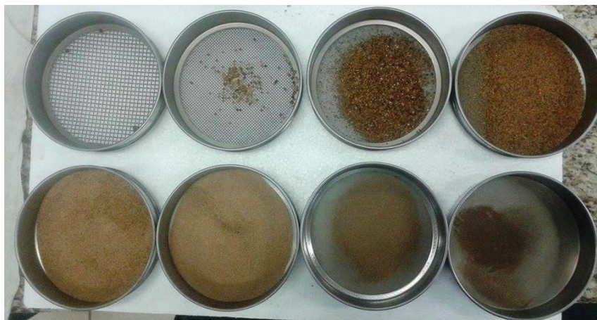
Figura 14 – Amostras dos grãos de agregados retidos em cada peneira de serie normal
