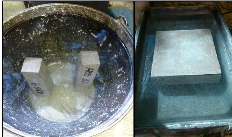
Figura 33 – Corpos-de-prova totalmente imersos em água
