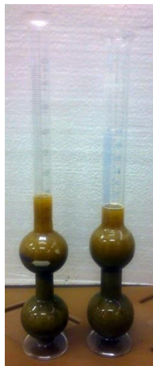
Figura 16 – Frasco de Chapman contendo o agregado miúdo
