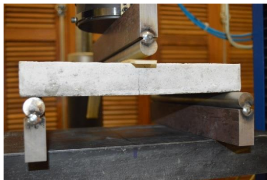
Figura 39 – Ensaio de flexão nas placas de argamassa
