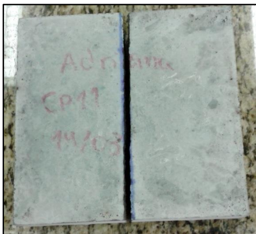
(a) placa de argamassa sem tela após a ruptura
