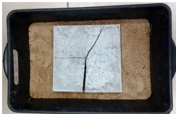
Figura 57 – Placa de argamassa sem tela após a ruptura por impacto
