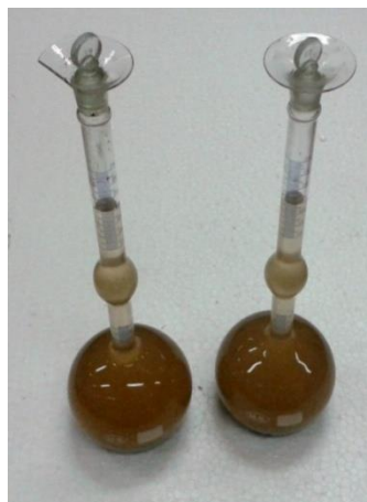
Figura 22 – Frascos de Le Chatelier contendo a amostra de aglomerante
