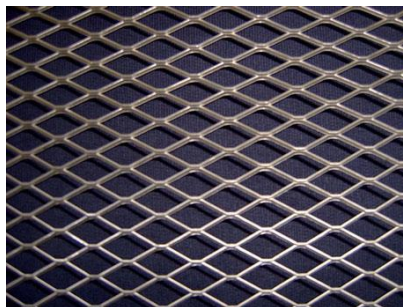
Figura 12 – Tela losangular de aço expandido Fonte: Telmetal (2014).
