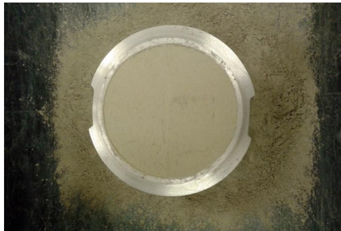
Figura 23 – Recipiente contendo o aglomerante após realização do ensaio de massa específica para o estado solto
