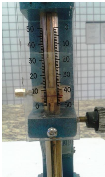
Figura 43 – Aparelho de Vicat depois de atingidos os 6 mm
