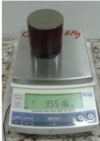
Figura 28 – Argamassa compactada no estado fresco
