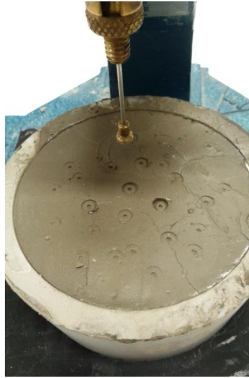
Figura 45 – Aparelho de Vicat depois de atingidos os 0,5 mm
