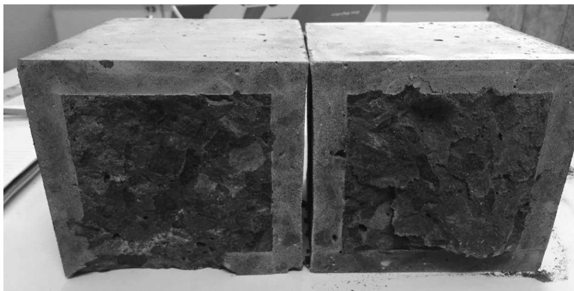
Figura 16: Exemplos de concreto C1 após a ruptura.
