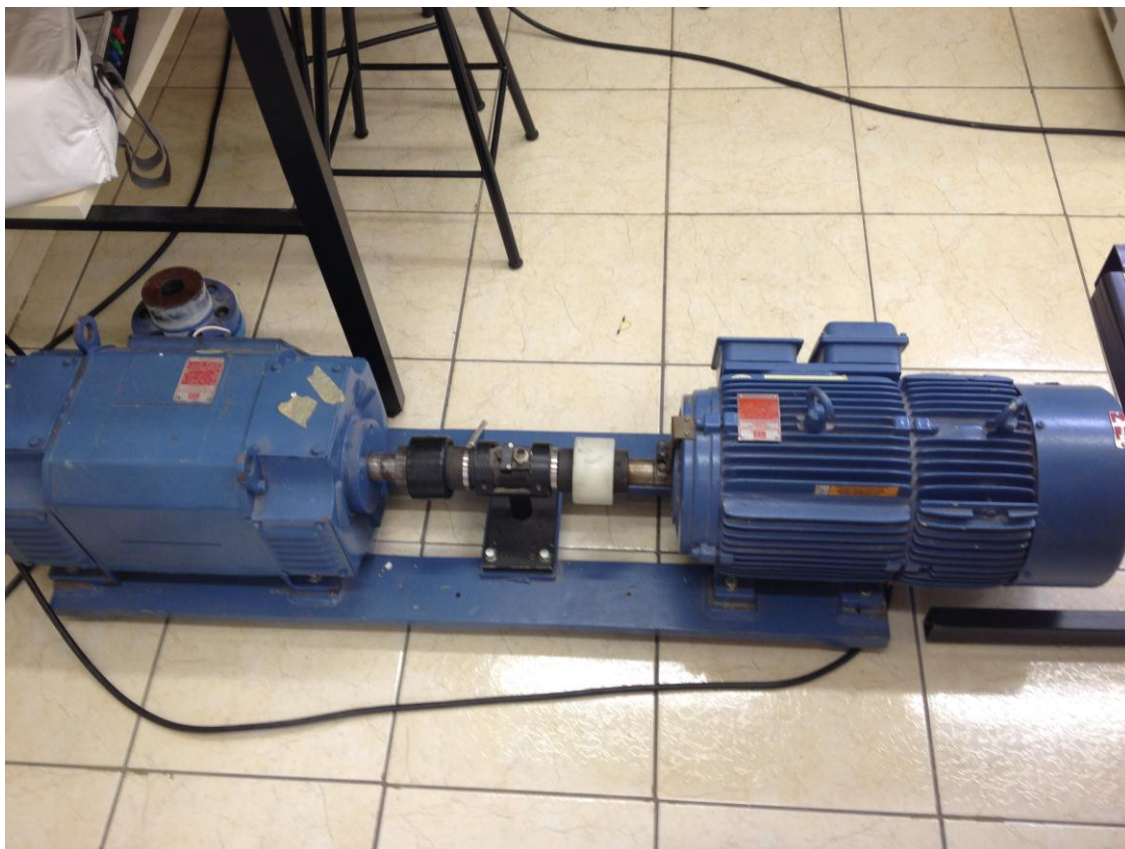
Figura 67 - Gerador de Indução acoplado a uma Máquina CC Fonte: Autoria Própria
