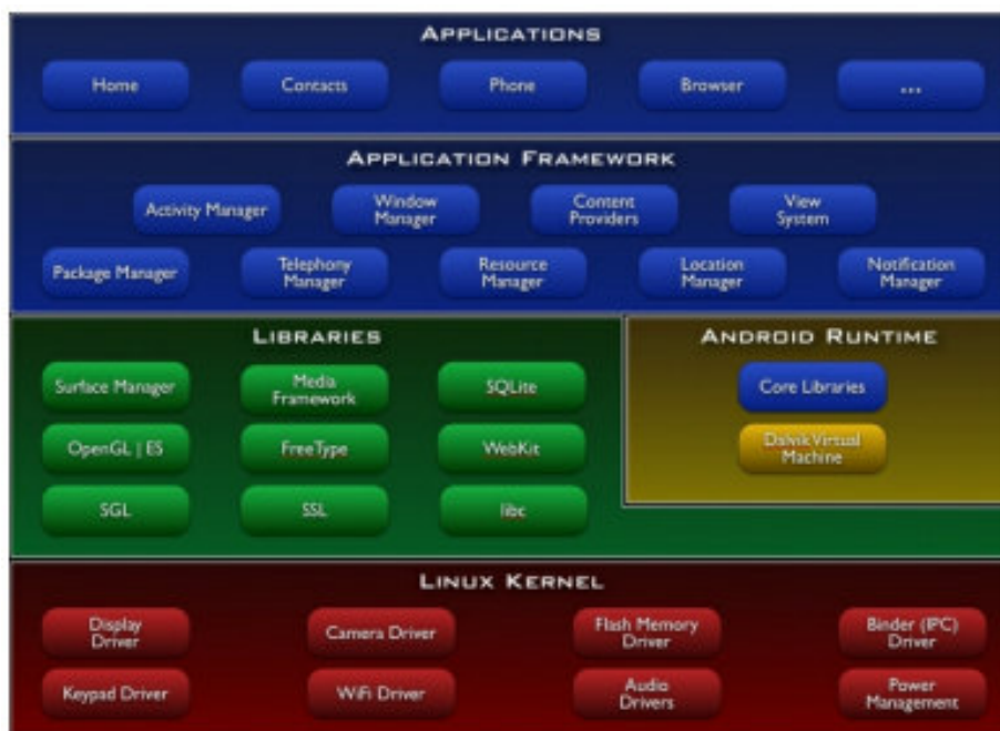
Figura 1 - Camadas de software do Android Fonte: Platform Versions (BORDIN, 2012)
