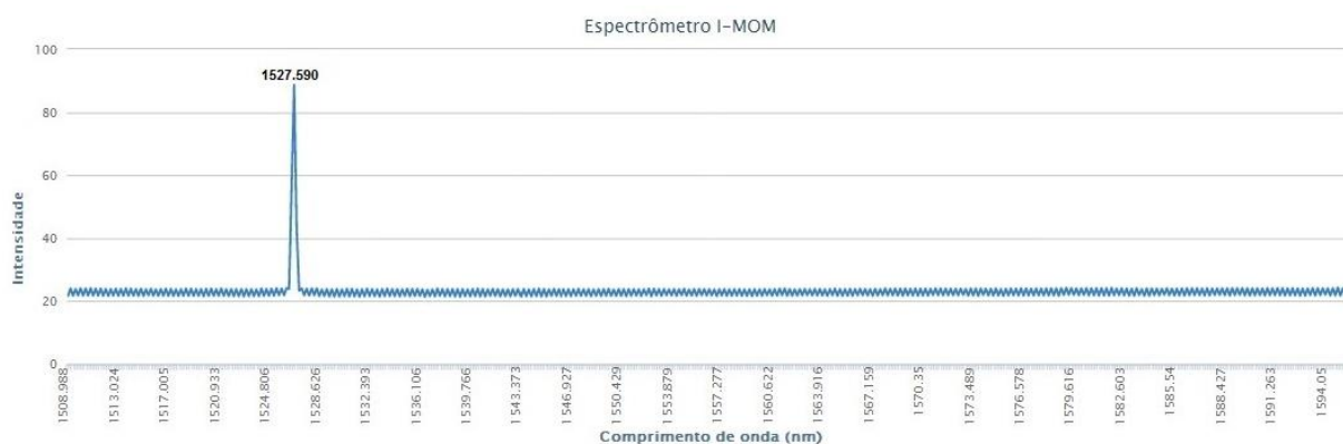
Figura 34: Espectro obtido pelo sistema desenvolvido mostrando a posição do pico de Bragg. A posição do pico corresponde a temperatura de 60°C. Fonte: Autoria própria.
