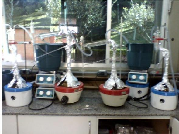
**Figura 5 - Sistema de Extração Cleverger**
