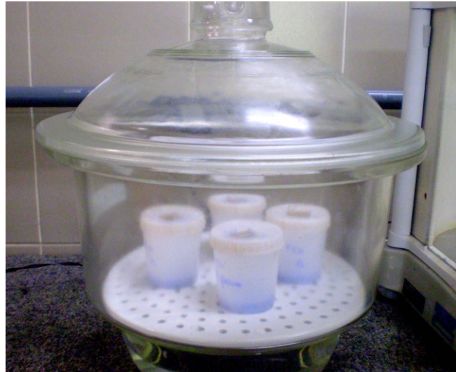
Figura 5 - Dessecador com as células utilizadas no teste de permeabilidade aos vapores de água.
